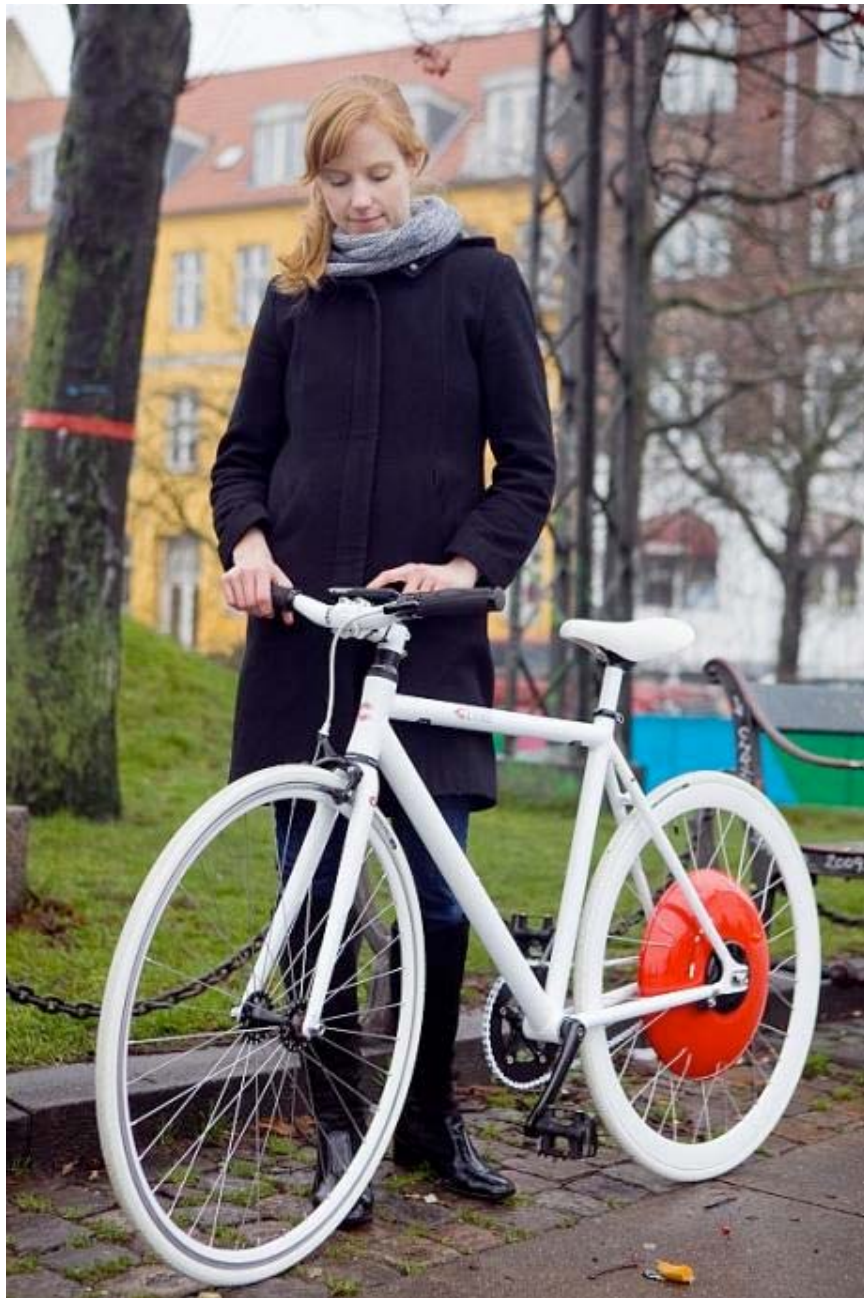
Den Kalorienverbrauch zeigt das am Lenker befestigte iPhone ebenso an wie die Luftverschmutzung. Die Daten kommen über die Bluetooth-Schnittstelle von Sensoren in der roten Radnabe.
